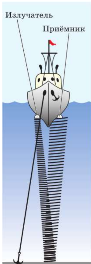
Рис. 124. Использование ультразвуковых колебаний для измерения глубины моря
