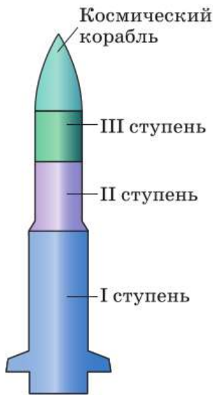
Рис. 86. Схема трёхступенчатой ракеты
