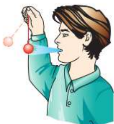
Рис. 129. Пример механического резонанса
