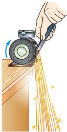
Рис. 23. Искры из-под стального прута, прижатого к вращающемуся точильному камню, летят по касательной к окружности в точке отрыва
