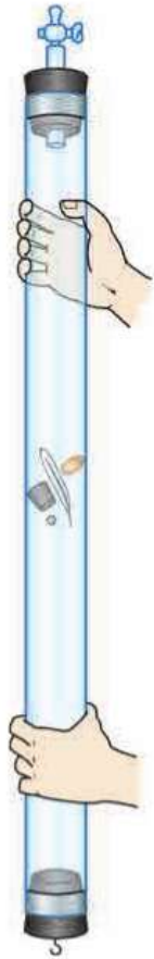
Рис. 42. Не испытывая сопротивления воздуха, все тела в трубке совершают свободное падение
