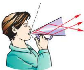
Рис. 128. Принцип действия рупора
