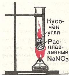
Рис. 26. Сгорание раскаленного угля в расплавленном нитрате натрия.
