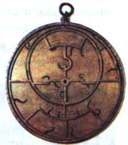
Астролябия — прибор для измерения углов с целью определения местонахождения корабля по расположению звезд.
