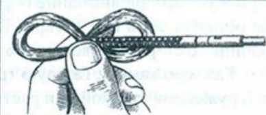
Рис. 64. Накладывание пакли на протирку.
