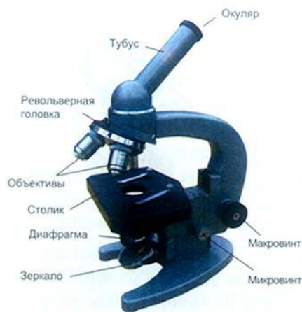
Рис. 34. Устройство оптического микроскопа
