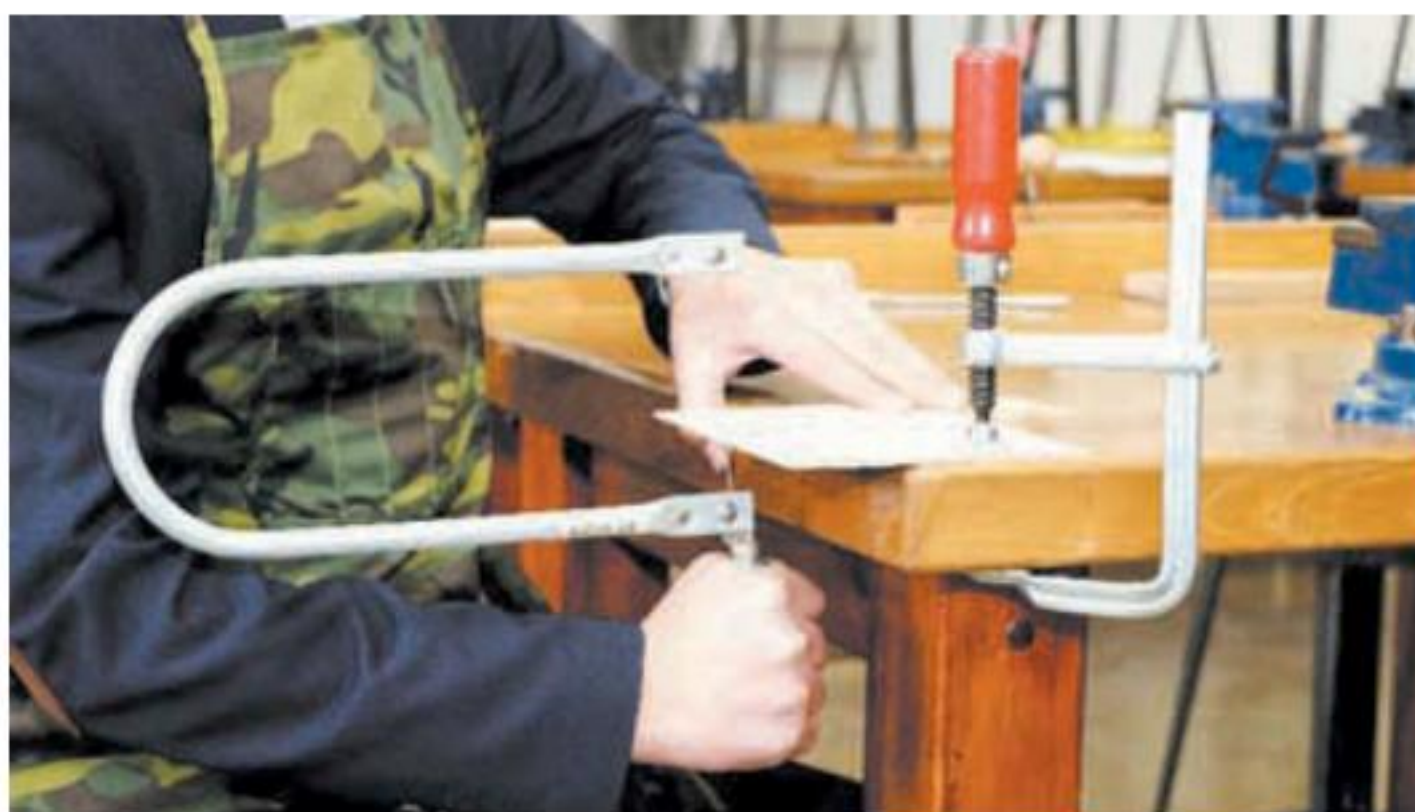
Рис. 72. 1. Выпиливание лобзиком. 2. Струбцина
