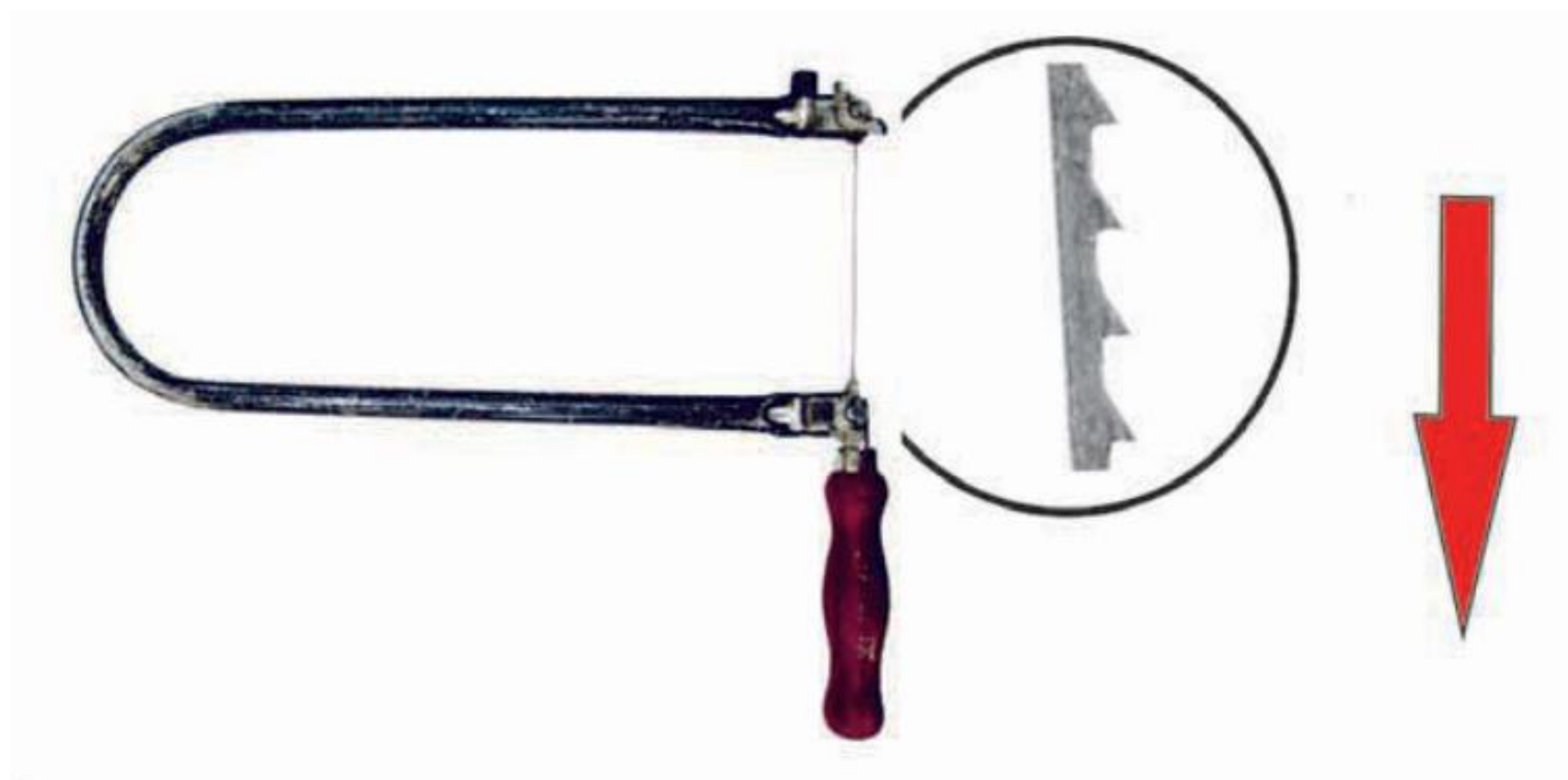
Рис. 71. Правильное направление зубьев лобзика
