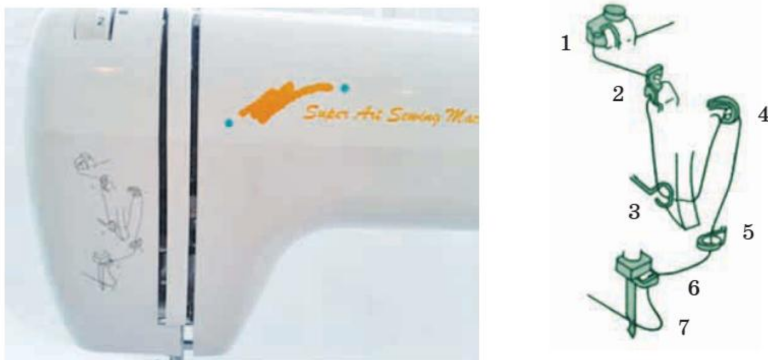
Рис. 65. Заправка верхней нитки
